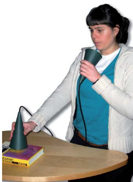
Med Bibfonen kan man både prata in och lyssna till meddelanden från boken. Bibfonen är tillverkad av trattar som är av samma slag som kyrkogårdsvaser. Foto: Det interaktiva barnbiblioteket.
