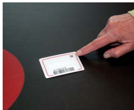
Baksidan av ett lånekort från Dieselverkstaden. Man ser det lilla chipset och den röda kretsen som är antennen. Foto: Anne-Marie Evers
